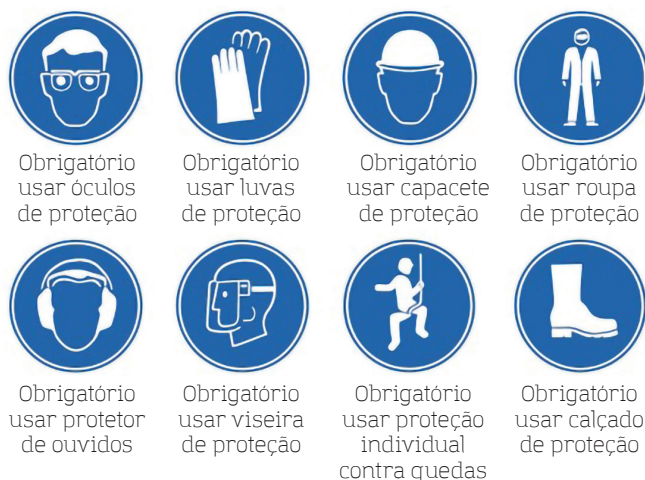
Figura 6.3. Exemplos de pictogramas de obrigatoriedade do uso de equipamentos de proteção individual (EPI).
