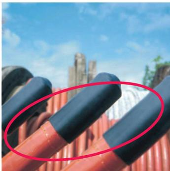
Figura 9.2. Selagem das pontas de cabo para posterior utilização.
