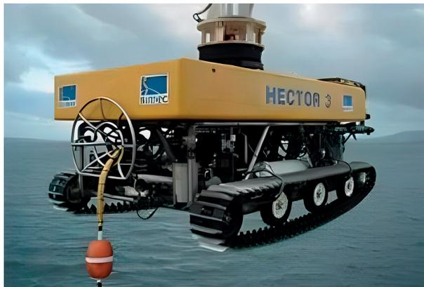
Figura 27.3. Robô para montagem de cabo submarino.
