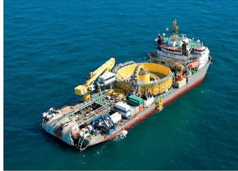
Figura 27.2. Embarcações para montagem de cabo submarino.
