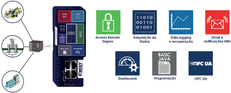
Figura 1.23. CARATERÍSTICAS DO ROUTER FLEXY 205.
