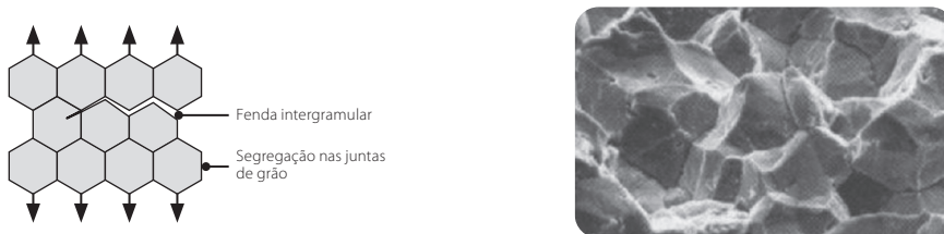
Figura 5.17. Rotura frágil de um metal através de falha intergranular.
