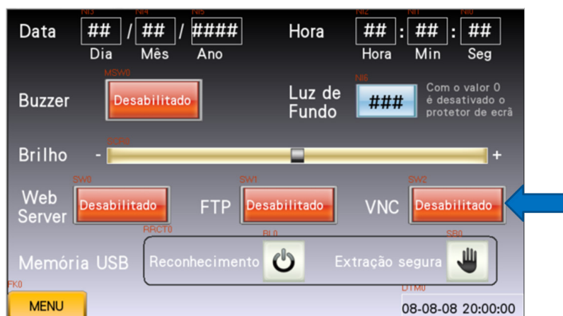
Figura 2.70. ADIÇÃO DE UM “BIT SWITCH” PARA HABILITAÇÃO DO SERVIDOR FTP
