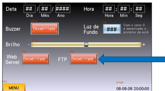
Figura 2.63. HABILITAÇÃO DO SERVIDOR FTP NA HMI ATRAVÉS DE UM OBJETO “BIT SWITCH”
