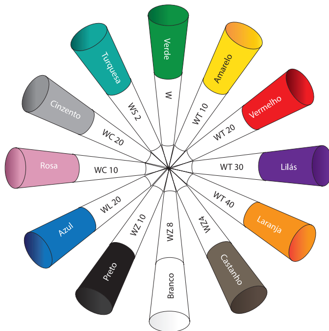
Figura 8.12. Convenção de cores para os eléctrodos de Tungsténio usados no processo de soldadura por plasma (igual ao usado no TIG) ( www.tungsten-electrodo.net ).
