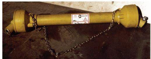
É essencial manter as proteções do veio em boas condições, e substituí-las sempre que apresentem defeitos que comprometam a segurança. Existe muita oferta no mercado, mas a empresa "Sparex" criou uma gama de proteções compatíveis com vários tipos de perfis e com diferentes comprimentos, sendo montadas facilmente, sem ferramentas, contribuindo fortemente para a segurança.
