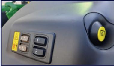
Aspetto do guarda-lamas traseiro de um trator, com os comandos para os braços hidráulicos e um botão de paragem da TDF. Desta forma, podemos parar a TDF em caso de emergência e manusear os hidráulicos com maior segurança. Tem ainda botões para comandar a saída hidráulica, por exemplo para um terceiro ponto hidráulico.
