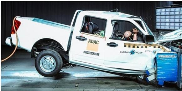
**Figura 8.4.** Ilustração de um teste de impacto de um veículo contra uma parede.
