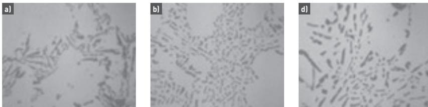
**FIGURA 1.6.** Modificação de uma liga Al7Si0.3Mg com tratamento de solubilização: **a)** estrutura bruta de fusão; **b)** solubilização a 540 °C durante 4 horas; **c)** solubilização a 540 °C durante 6 horas.
