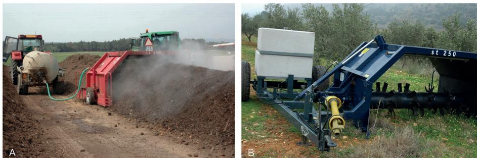
**Figura 4.35.a,b.** Movimentador de pilhas de composto, acionado pelo trator em marcha lenta, com rega simultânea com reboque cisterna ligado ao movimentador (a) (Odemira, 2005); equipamento semelhante estacionado (b) (Torre de Moncorvo, 2004).
