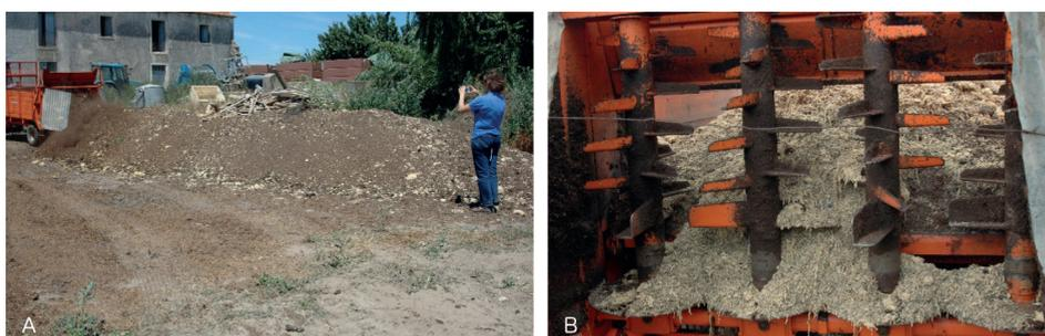
**Figura 4.36.a,b.** Reboque distribuidor de estrume, carregado com carregador frontal, com carnoz (na foto) e estrume de cavalo, para misturar e fazer a pilha (a); pormenor das pás do reboque distribuidor onde os materiais são misturados (b) (Cartaxo, 2005).
