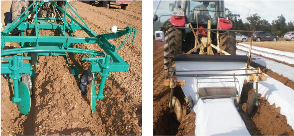
**Figura 5.10.** Armador de camalhões (esquerda) e armador de camalhão com aplicação de polietileno em simultâneo (direita) <sup>[91]</sup>.
