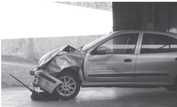
Figura 67. Exemplo da deformação da frente de um carro.
