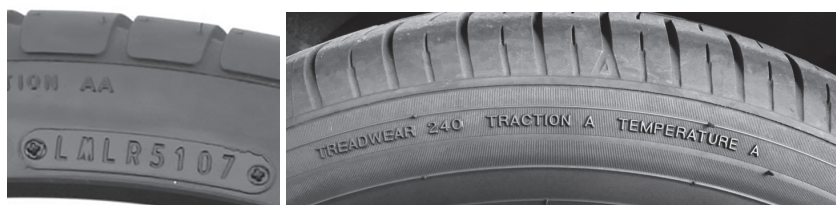
Figura 99. Especificações de pneus: Esquerda: pressão e carga máximas; Direita: índices de durabilidade, tração e temperatura.
