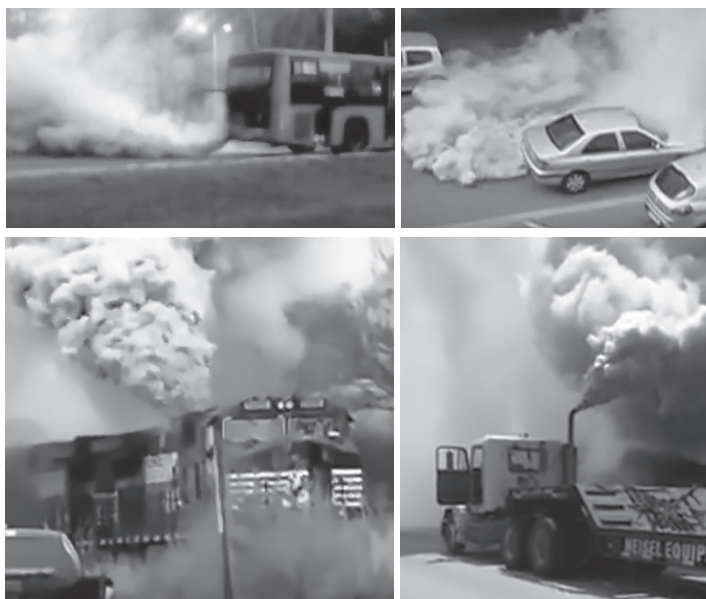
Figura 135. Diesel runaway em motores de vários veículos.
