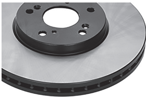
Figura 106. Disco de travão com arrefecimento interno.
