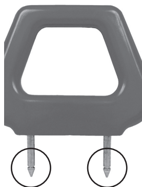
Figura 81. Apoio de cabeça com terminação em ponta.
