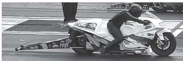
Figura 52. Moto dragster , com traseira longa para não levantar a roda da frente.
