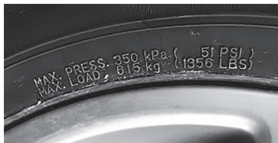
Figura 98. Especificações de pressão e carga máximas.
