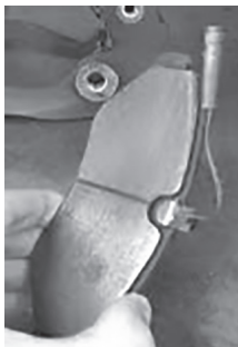
Figura 107. Pastilhas de travão com indicador de uso.
