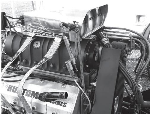
Fig.4.38 - Compressor Roots de um dragster top fuel
