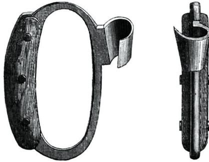
**Figura 1.6** Marcador florestal. Marcação de traço horizontal no tronco, sobre a casca, ao nível do diâmetro da árvore (DAP), para medição; marcação de traço oblíquo para contagem (Gurnaud, 1890).
