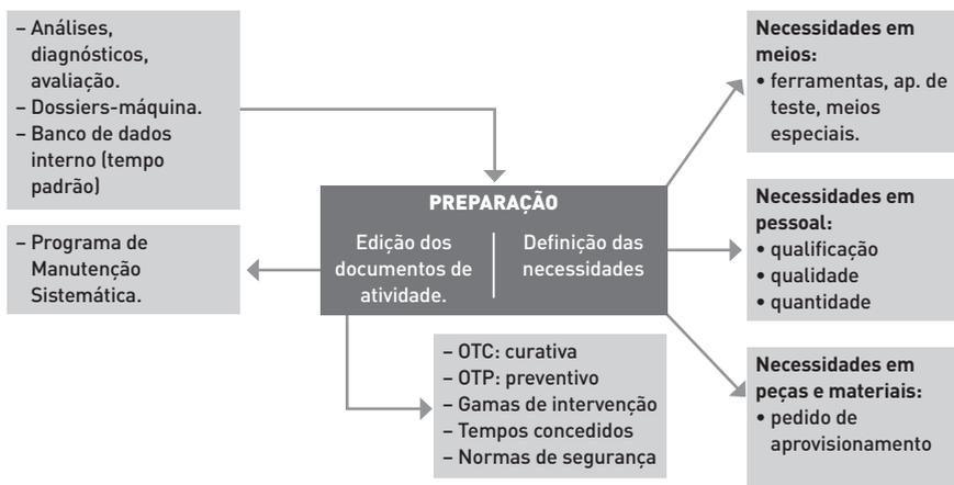
**FIGURA 7.1.** | Preparação da Manutenção.
