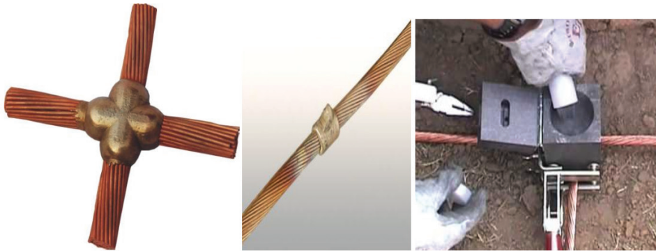
Figura 17.1. – Exemplos de soldadura aluminotérmica (esquerda e centro) e preparação da soldadura (direita)
