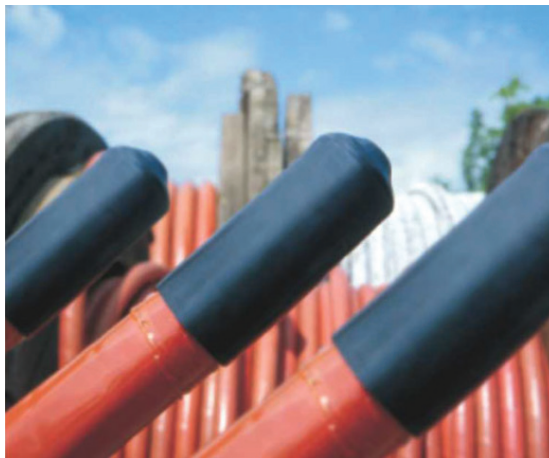
Figura 26.11. – Selagem das pontas de cabo para posterior utilização
