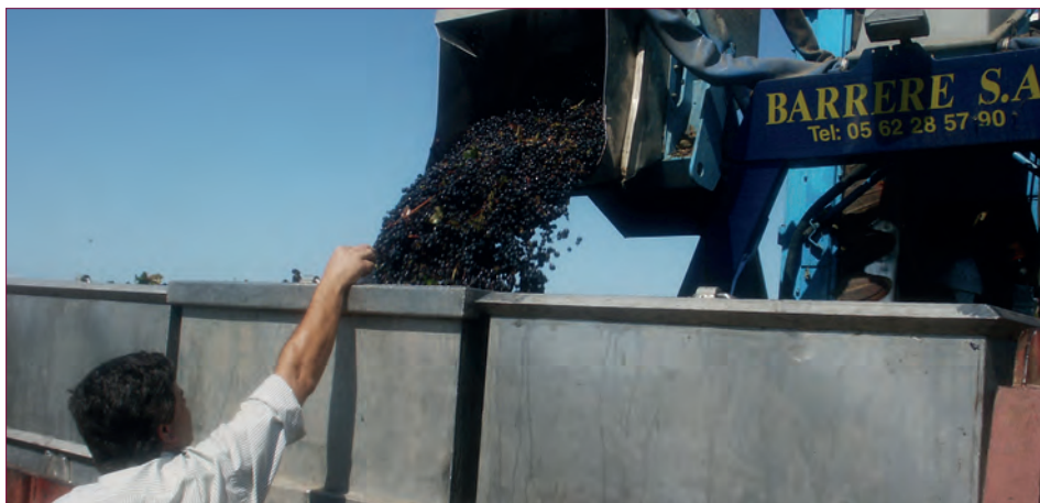
Figura 3.2. – Descarga da uva da máquina de vindima por um dos depósitos laterais basculantes.
