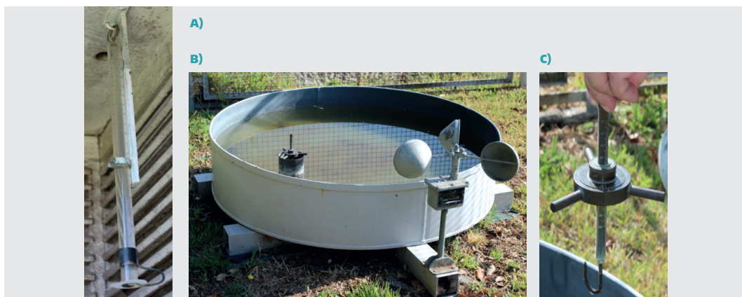
Fig. 7.1 (A) Evaporímetro de Piche colocado em abrigo meteorológico do tipo Stevenson. (B) Tina de evaporação US Class A, em que se pode ver o poço amortecedor no seu interior onde está colocado o parafuso micrométrico para medir o nível da água. (C) Parafuso micrométrico.
