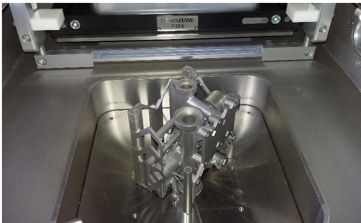
Figura 6.1 – Peça obtida por impressão 3D de metal
