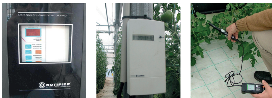
Figura 79 – Equipamento para deteção CO (à esquerda) e de CO 2 (fixo, ao centro, e portátil, à direita).
