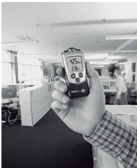
Figura 1.2: Medição de temperatura, com NTC, e humidade com sensor capacitivo
