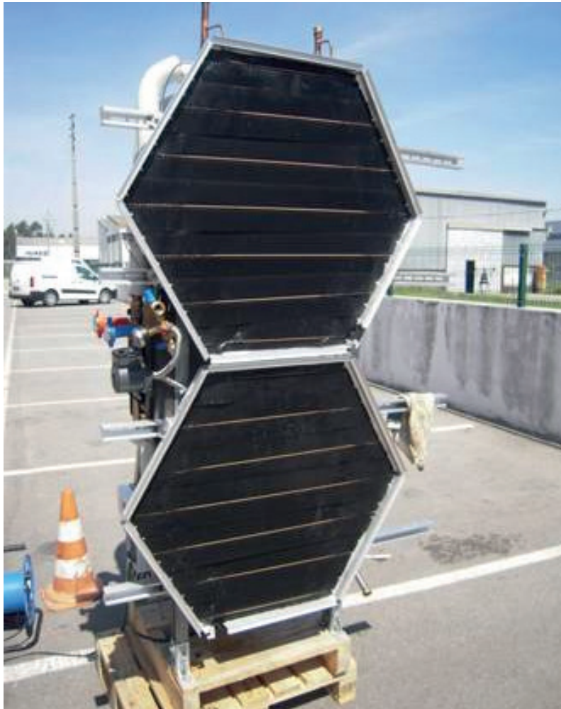
Protótipo alfa de um painel solar. Estes protótipos são construídos com os mesmos materiais e geometrias finais, mas não, necessariamente, com os processos de fabrico e montagem definidos no projeto. Estes protótipos permitem ter uma perceção real do funcionamento do produto (Raquel Salomé, Tese de Doutoramento, Faculdade de Engenharia da Universidade do Porto)
