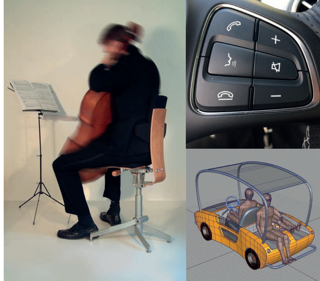
Estudo de uma cadeira para músicos de instrumentos de corda (cortesia de Gearoid Ó Conchubhair, Tese de Doutoramento, National College of Art and Design, Irlanda); Interface de comando de veículo concebido e projetado em função do condutor; Modelo digital de carro maca em que as condições antropométricas e ergonómicas assumem necessária importância no projeto (INDI - Escola Superior de Artes e Design)
