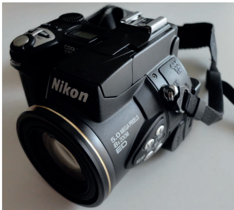
Corpo de máquina fotográfica em liga de magnésio
