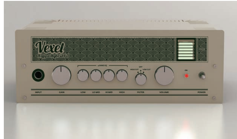
Protótipo beta do amplificador Vexel Kappa-60. Este tipo de protótipos é fabricado com os processos de fabrico finais, mas os seus componentes não são, necessariamente, ligados como especificado para a montagem. Estes protótipos são ensaiados antes do fabrico e montagem final (David Marques, Dissertação de Mestrado em Design, Escola Superior de Artes e Design)
