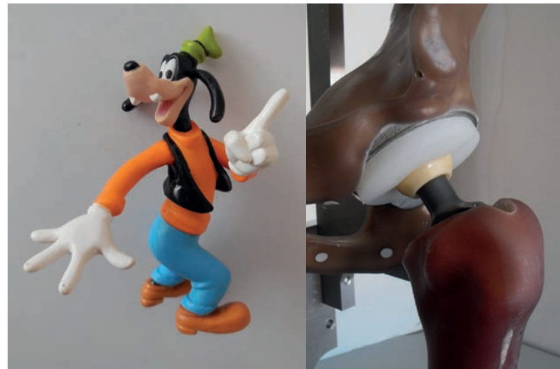
O polietileno é um plástico de grande aplicabilidade no desenvolvimento de produtos. O de ultra elevada densidade é utilizado para fabricar próteses articulares (na figura da direita mostra-se um componente acetabular de polietileno a articular com uma cabeça femoral cerâmica)
