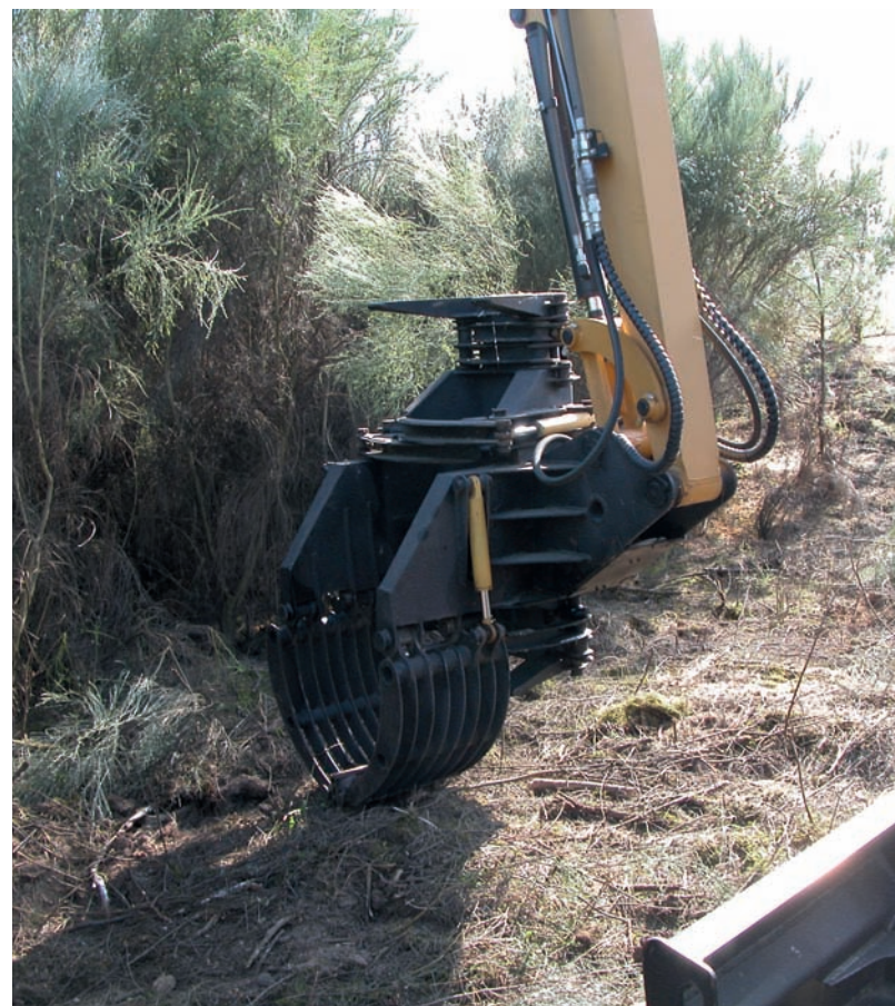
Protótipo beta de equipamento de recolha de vegetação florestal
