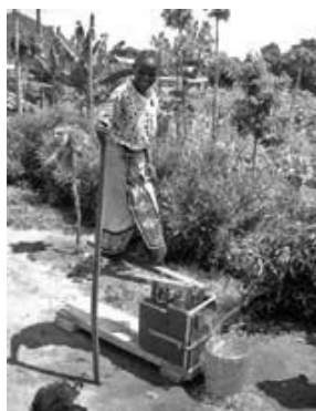
Figura 78: Bomba de pedal: A , por gravidade; B , por pressão.
