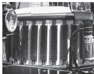
Fig.5.84 – Arrefecedor da água de um motor antigo (tubos com alhetas circulares)
