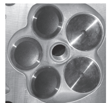
Fig.8.35 – Câmara de 5 válvulas
