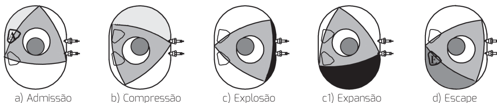
Fig.1.14 – Ciclo de funcionamento do motor Wankel
