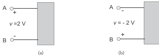
Figura 1.5 - Representações equivalentes para a mesma tensão: (a) terminal A é 2 V positivo em relação a B; (b) terminal B é -2 V positivo em relação a A.
