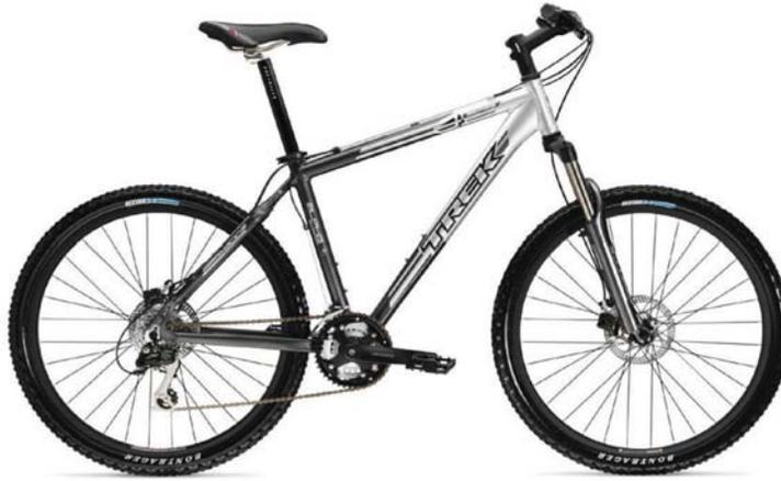
Figura 2 - Bicicleta cujo quadro é fabricado em construção soldada.
