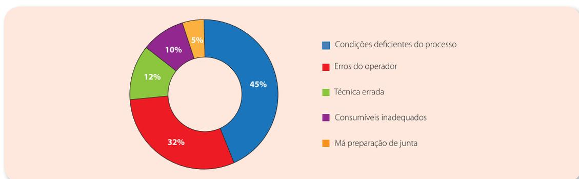
Figura 284 - Principais causas para o aparecimento de defeitos de soldadura (Fonte: ASME).
