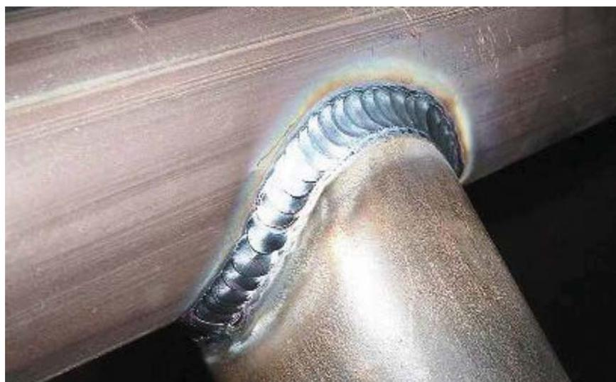
Figura 135 - Aspeto de uma soldadura TIG realizada com material de adição.
