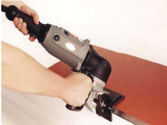
**Figura 17** - Rebarbadora equipada de forma apropriada para a realização de chanfros em peças planas.
