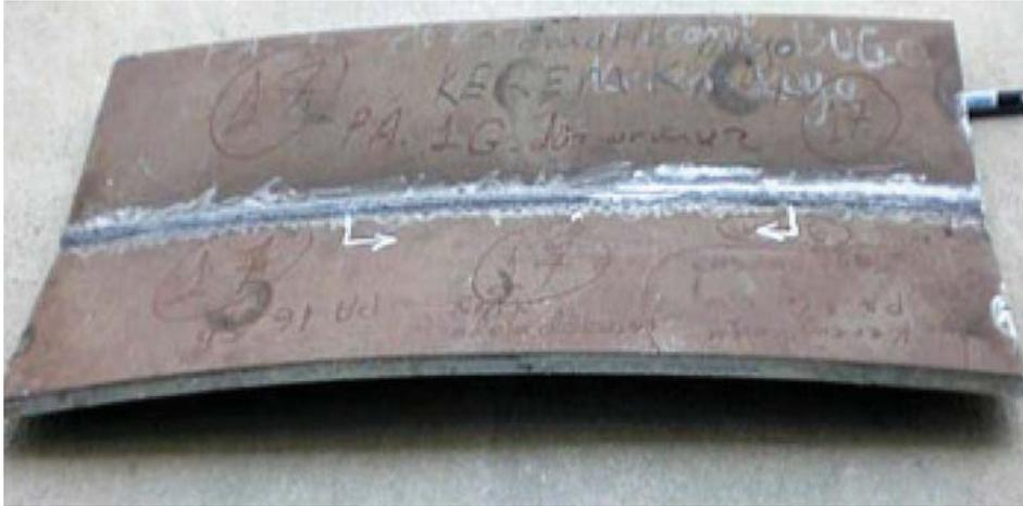
**Figura 290** – Efeito de contração registado numa soldadura topo-a-topo de duas chapas de aço, em que é possível observar o efeito de dupla encurvadura, isto é, tanto no sentido longitudinal como transversal (Fonte: hera.org.nz, em 06.01.2014).
