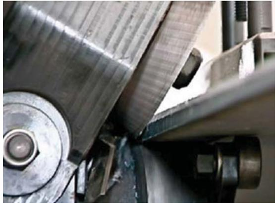
**Figura 18** - Equipamento apropriado para a abertura de chanfros em peças planas (Ananda Shipyard and Slipways, Ltd.).
