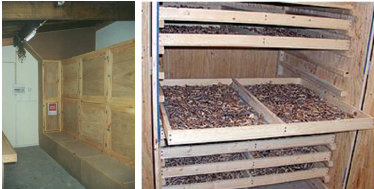
FIGURA 3.12 - Secador híbrido e pormenor de tabuleiros com cogumelos secados.
