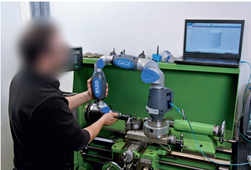
Figura 11.1 › Controlo dimensional durante o processo (cortesia FARO Technologies, Inc.)
